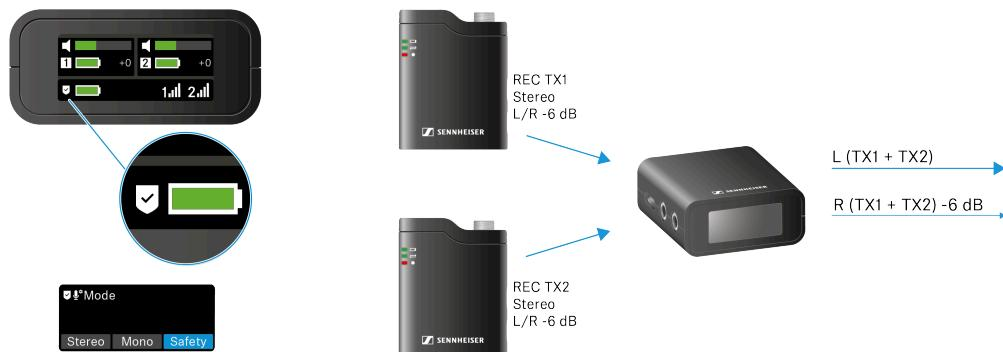
O modo de segurança funciona basicamente da mesma forma que o modo mono, mas aqui o canal direito é emitido a -6 dB no sinal de áudio misturado da saída do receiver. Esta faixa mais silenciosa é uma característica de segurança no caso de o som ficar sobrecarregado durante a gravação na câmara.
