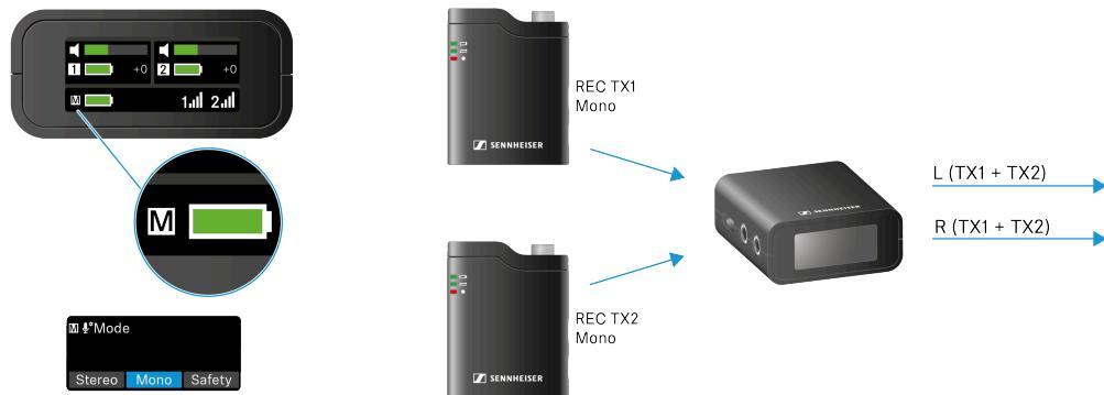
O **modo Mono** é ideal caso se pretenda utilizar uma saída de áudio simétrica (esquerda/direita) num dispositivo (por ex., câmara ou smartphone) que suporta apenas um canal de entrada. Neste caso, os sinais de ambos os transmitters es são misturados no receiver e fornecidos como um sinal idêntico nas saídas esquerda e direita do receiver. No entanto, os sinais de áudio dos transmitters es não podem ser processados separadamente na pós-produção.
