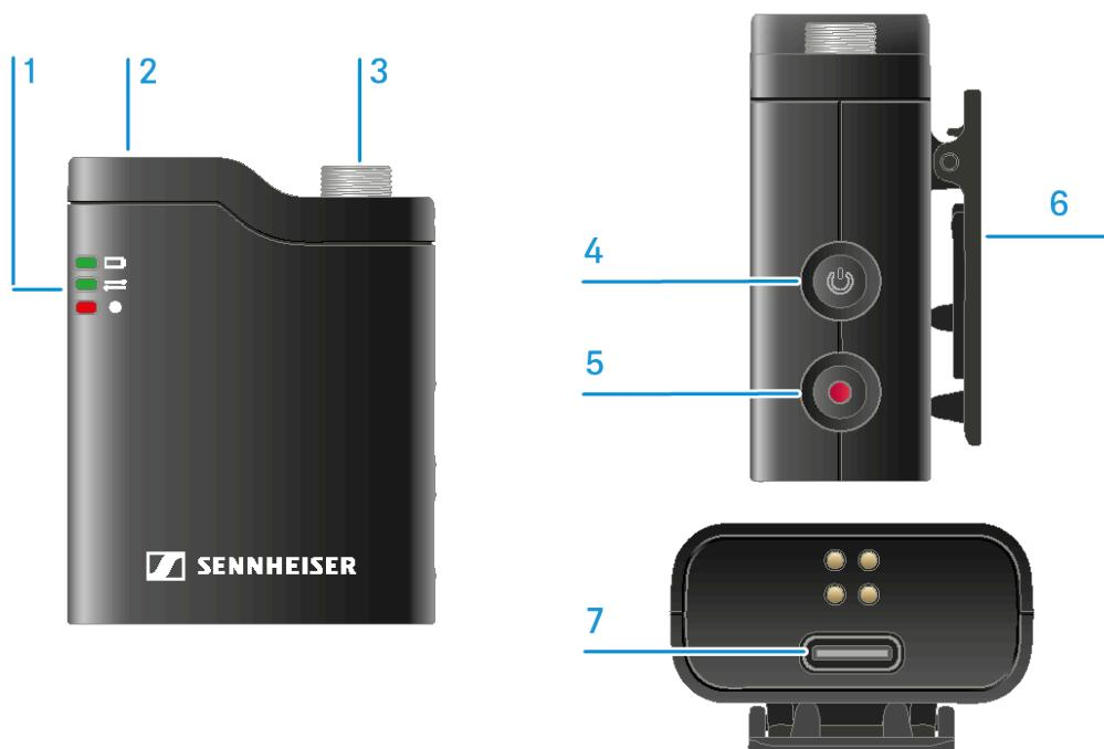
**1** LED para indicação do estado da bateria, do estado da ligação e do estado da gravação
