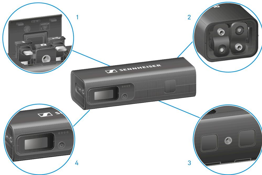
**1** Compartimento articulado com três adaptadores: USB-C, Lightning e sapata
