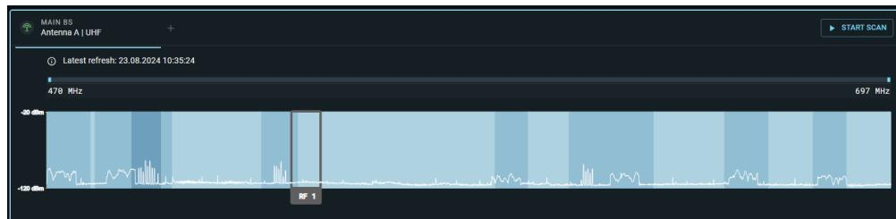
Avant d'activer l'antenne connectée, vous pouvez vérifier l'occupation du spectre des fréquences et examiner les environs pour identifier d'éventuelles interférences de fréquences.
