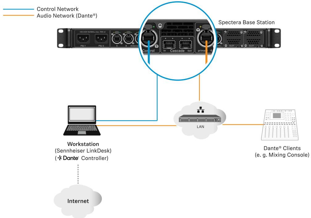
Dans cette configuration, un poste de travail est utilisé pour toutes les applications logicielles client (Sennheiser LinkDesk, Spectra WebUI, Dante® Controller). Soit deux interfaces de réseau filaire séparées sont utilisées pour la commande et l'audio (Dante®), soit une interface est partagée. Veuillez noter que, dans ce type de configurations (en général), aucun service DHCP n'est activé. Utilisez les paramètres IP manuels ou la configuration ZeroConf.
