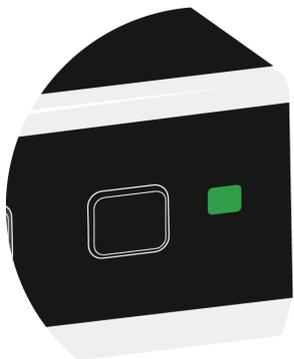
La tecla PAIR se ha mantenido pulsada. El receptor establece una conexión inalámbrica a un transmisor en el que la tecla PAIR también se ha mantenido pulsada.
