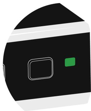
La conexión inalámbrica al transmisor está establecida. La pila recargable del transmisor recibido tiene suficiente capacidad.
