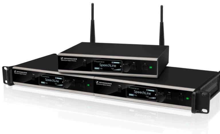
El receptor fijo de 9,5" SL Rack Receiver DW es el corazón del sistema SpeechLine Digital Wireless. Gracias a la comunicación bidireccional entre el receptor fijo y el transmisor, todos los ajustes de los transmisores móviles se pueden realizar desde el receptor. La gestión automática de frecuencias del receptor hace innecesarios los ajustes de frecuencia manuales y la gestión automática de interferencias garantiza la máxima seguridad en la transmisión.
