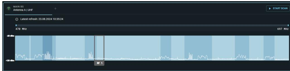
Antes de activar la antena conectada, puede comprobar la ocupación del espectro de frecuencia y examinar el entorno para detectar posibles interferencias de frecuencias.
