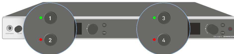
Los cuatro ledes de la parte frontal del receptor pueden mostrar la siguiente información para el canal 1, el canal 2, el canal 3 y el canal 4, respectivamente.
