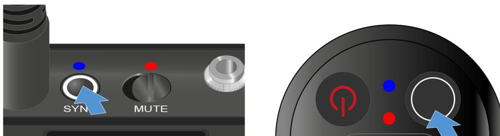
✓ El transmisor y el receptor se sincronizan. Cuando la conexión está establecida, el led **LINK** de ambos aparatos se ilumina en verde.
