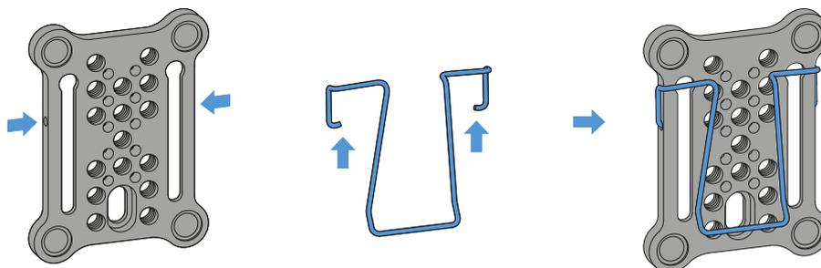
Como alternativa al adaptador de zapata para flash se puede montar un clip de metal lateralmente en la placa de montaje.
