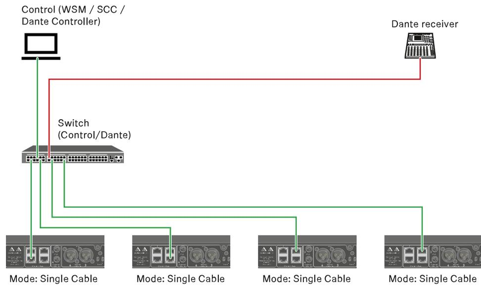
**i** El cable puede conectarse a las conexiones de red I, II o III.
