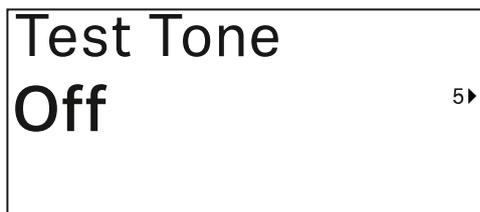
En esta opción de menú se puede activar un tono de prueba para que lo transmita el transmisor en lugar de la señal de entrada. Utilice esta función, por ejemplo, para ajustar el volumen del sistema.
