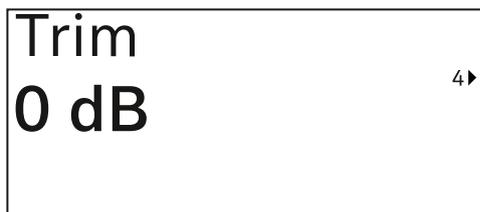
En esta opción de menú, puede ajustar el nivel de audio del transmisor a diferentes volúmenes de la ganancia de entrada además de la ganancia de la señal de radio (solo ajustada en el receptor).
