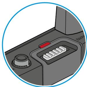
**LED se ilumina en rojo:** No hay conexión inalámbrica a un receptor. Además, en la pantalla se visualiza el mensaje
