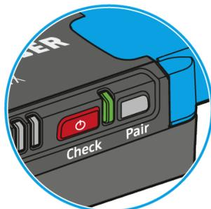
**LED se ilumina en verde:** La conexión inalámbrica al transmisor está establecida. El pila recargable del transmisor recibido tiene suficiente capacidad.
