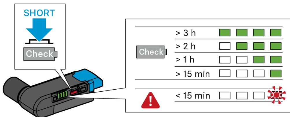
Si, independientemente de si se ha pulsado o no la tecla **On/Off/Check**, un LED del indicador LED de cuatro niveles parpadea en rojo, la capacidad del pila recargable BA 20 ha bajado tanto que sólo queda una autonomía de menos de 15 minutos.
