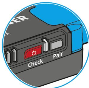
**LED parpadea en rojo:** Al pila recargable del transmisor recibido le queda capacidad para un máximo de 15 minutos.
