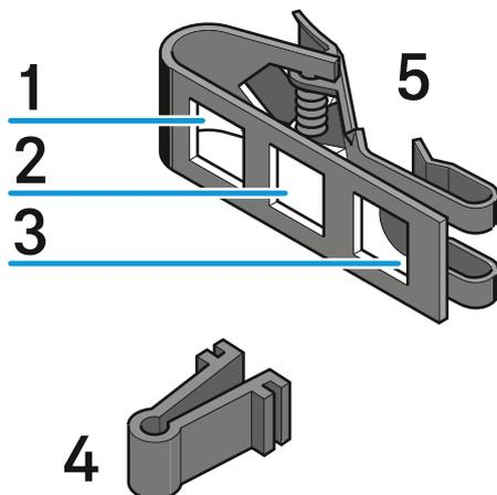
Junto con el micrófono de clip ME 2 se suministra una pinza en dos partes:
