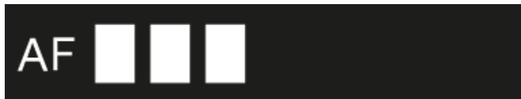
Beim Empfänger kommen Audiosignale eines Senders an, welcher die selbe Frequenz verwendet.
