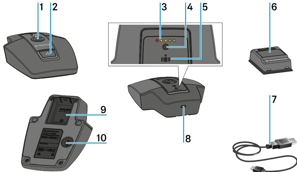
1 XLR-3-Buchse zum Anschließen eines Schwanenhalsmikrofons
