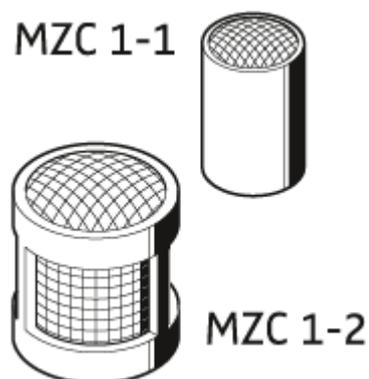
Zusätzlich bietet die große Frequenzgangkappe eine Windschutzdämpfung von ca. 15 dB und deutlich erweiterten Schutz vor eindringender Feuchtigkeit.
