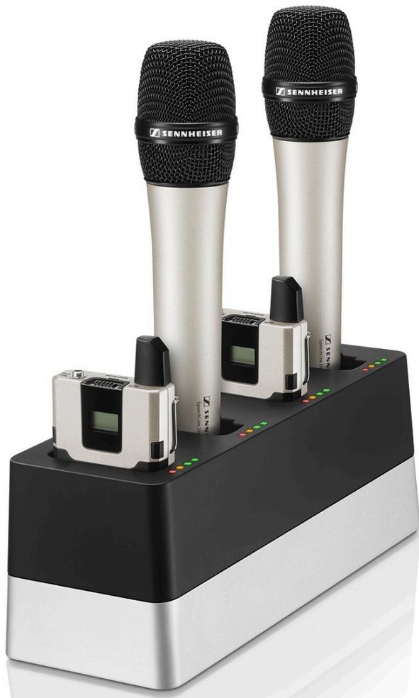
Der CHG 4N ist ein netzwerkfähiges Ladegerät mit vier individuellen Ladeschächten. Diese können sowohl für den SL Bodypack DW als auch für den SL Handheld DW genutzt werden. Die vier LEDs an jedem Ladeschacht zeigen den aktuellen Ladestatus an. Die flexible Netzwerk-Schnittstelle erlaubt IPv4- und IPv6- Kompatibilität für eine nahtlose Integration. Alle Einstellungen und Statusinformationen können mit der Steuerungssoftware Sennheiser Control Cockpit überwacht und ferngesteuert werden.
