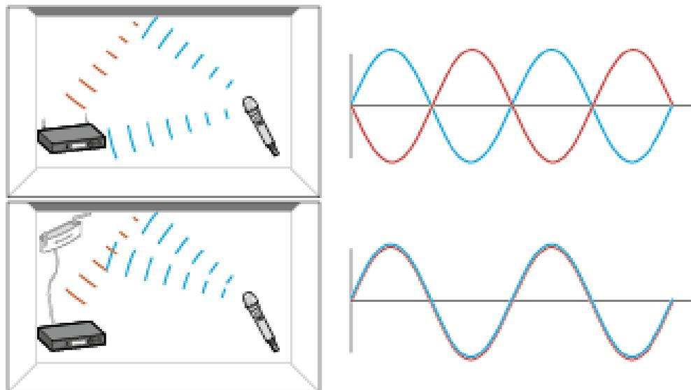
Das Signal wird von der elektrisch leitenden Fläche reflektiert. Im schlimmsten Fall können das blaue Signal und das rote reflektierte Signal phasenverschoben am Empfänger ankommen, sodass die beiden Signale sich gegenseitig auslöschen.
