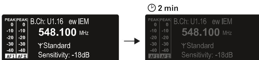
Besteht keine Funkverbindung zu einem Empfänger, schaltet sich das Display nach 20 Minuten aus. Durch drücken einer beliebigen Taste wird das Display wieder aktiviert.
