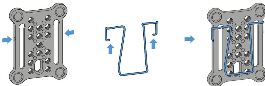
Alternativ zum Blitzschuhadapter kann ein Metallclip seitlich an der Montageplatte angebracht werden.
