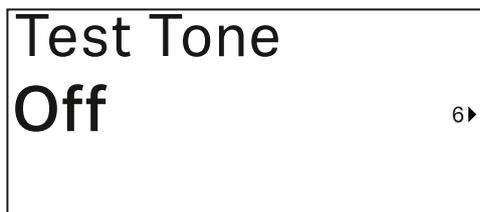
In diesem Menüpunkt können Sie einen Testton aktivieren, den der Sender anstelle des Eingangssignals überträgt. Nutzen Sie diese Funktion z. B. zum Einpegeln des Systems.
