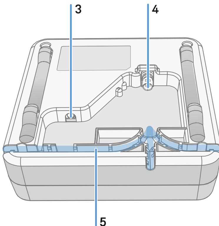
3 Anschlussbuchse **DC in** für das Steckernetzteil
