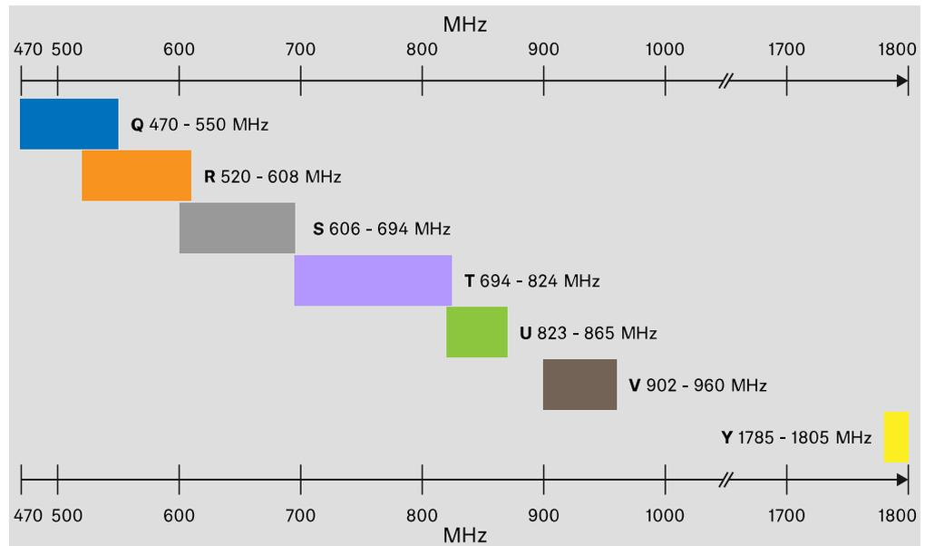
Der Antennen-Splitter **EW-D ASA** ist in den folgenden Frequenzbereichen erhältlich:
