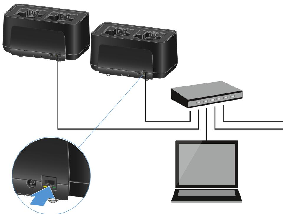
Sie können die Geräte einzeln in das Netzwerk einbinden oder bis zu 5 Ladegeräte kaskadieren (siehe [Ladegeräte kaskadieren](#)).
