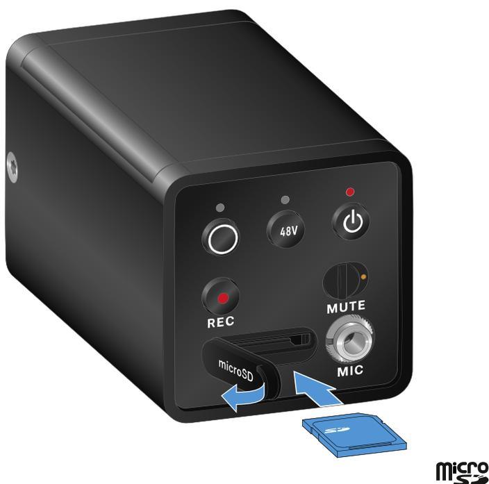
**i** Das Herausnehmen der microSD Karte während einer laufenden Aufnahme kann zu einer zerstörten Aufnahme datei führen.
