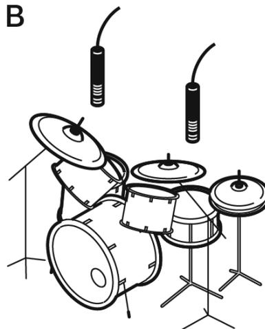
Um Störungen durch Übersprechen von benachbarten Schallquellen zu vermeiden, versuchen Sie, das Mikrofon so zu positionieren, dass die Störschallquelle im Winkelbereich der größten Auslöschung des Mikrofons liegt (180°, s. [Polardiagramm](#)).
