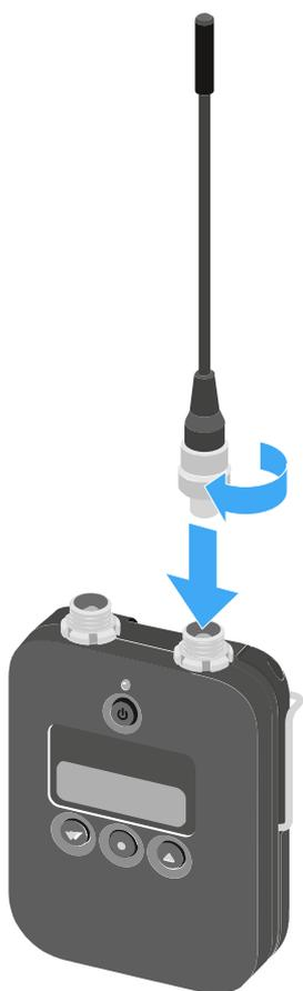
**i** Die Antenne lässt sich ganz leicht in nur einer Ausrichtung in die Antennenbuchse stecken. Stecken Sie die Antenne nicht mit Gewalt in die Antennenbuchse des Taschensenders.
