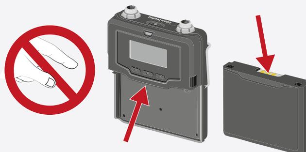
Vor der Verwendung des Batteriefaches müssen Sie erst wie in der Abbildung dargestellt Batterien einsetzen.
