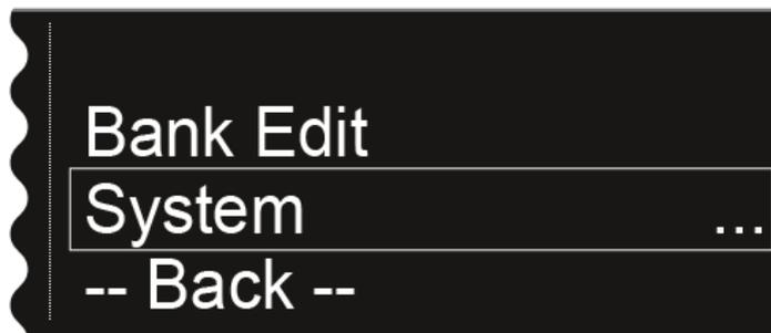
Im Display des Kanals CH 1 werden im Bedienmenü zusätzlich die Systemeinstellungen für das ganze Gerät angezeigt. Siehe [Menüpunkt System](#).
