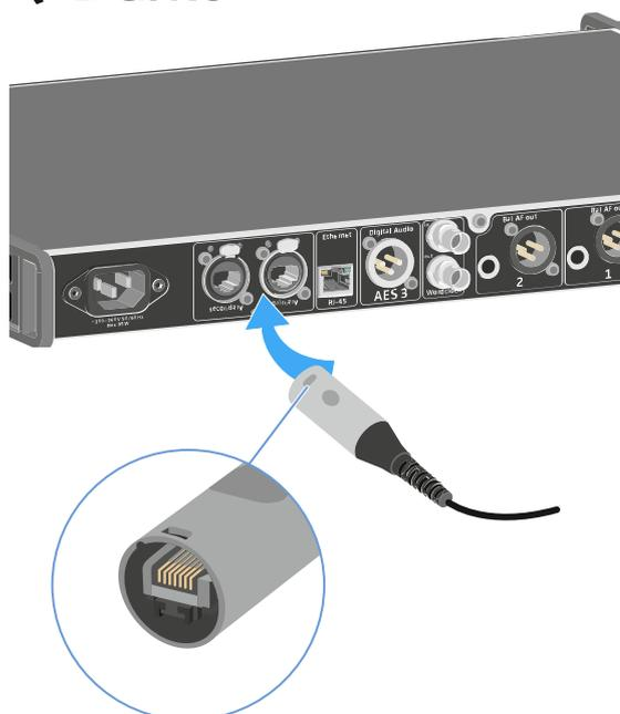
**i** Wir empfehlen, einen Ethernet Connector wie in der Abbildung dargestellt zu verwenden.
