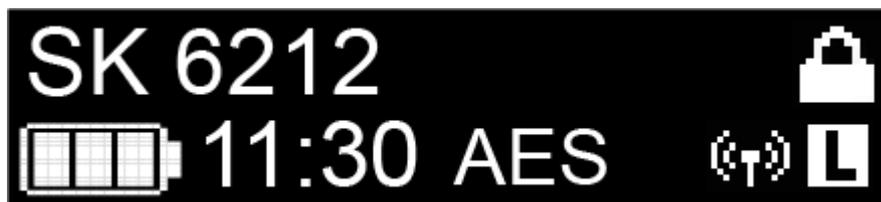
Im Home Screen wird der Name der Funkverbindung angezeigt.
