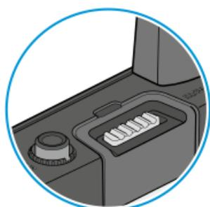
**LED blinkt grün:** Die Taste **Pair** wurde kurz gedrückt. Der gekoppelte Sender wird identifiziert.
