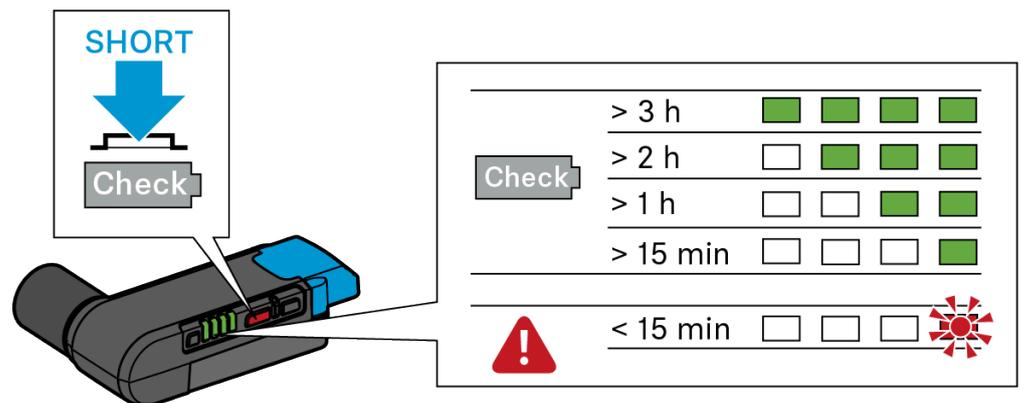
Wenn – unabhängig davon, ob die Taste **On/Off/Check** gedrückt wurde – eine LED der vierstufigen LED-Anzeige rot blinkt, ist die Kapazität des Akkus BA 20 soweit gesunken, dass nur noch eine Laufzeit von weniger als 15 Minuten verbleibt.
