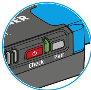
**LED leuchtet grün:** Die Funkverbindung zum Sender ist hergestellt. Der Akku des empfangenen Senders hat ausreichend Kapazität.
