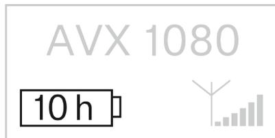
Wenn die Kapazität des Akkus soweit gesunken ist, dass nur noch eine Laufzeit von weniger als 30 Minuten verbleibt, blinken die Status-LEDs an Sender und Empfänger rot.
