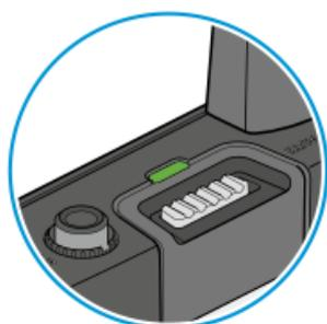
**LED blinkt abwechselnd grün und rot:** Die Taste **Pair** wurde lang gedrückt. Der Taschensender stellt die Funkverbindung zu einem Empfänger her, an dem ebenfalls die Taste **Pair** lang gedrückt wurde.
