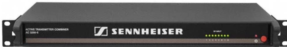
Aktiver 8-Kanal-Antennencombiner für große drahtlose Monitorsysteme. Bündelt bis zu 8 Eingangssignale mit max. 100 mW pro Kanal auf eine Antenne. Unterdrückt effektiv Intermodulationen; gewährleistet über LEDs einen schnellen Überblick über alle Eingangskanäle.
